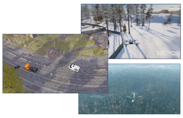
Программная часть тренажера представляет собой симулятор физических характеристик реального многороторного дрона (мультикоптера), воссозданного в виде компьютерной модели. Поведение виртуальной модели аппарата соответствует поведению реального БПЛА в воздухе. Управление тренажером осуществляется через компьютерный джойстик, функционирование клавиш на котором приведено в соответствие с функционированием клавиш на пульте управления БПЛА. Программа
